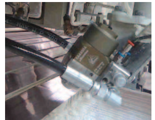
Materialführende Teile mit leichtem Zugang zur Farbkolbendichtung.
