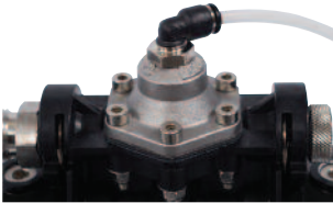
Der eingebaute Materialdruckregler sorgt für eine leicht regulierbare und impulsfreie Förderung des Materialflusses. Bei Konkurrenzmodellen ist dieses Bauteil kostenpflichtig.
